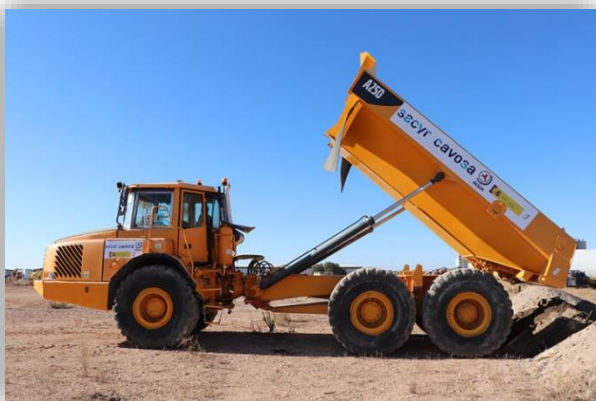
Volquete autónomo para obra civil de SACYR y CAVOSA
