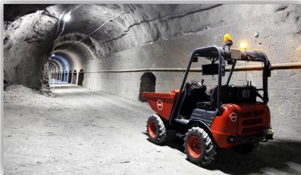
Dúmpster autónomo desarrollado por ITAINNOVA, VIAS, ANMOPYC y UNIZAR
