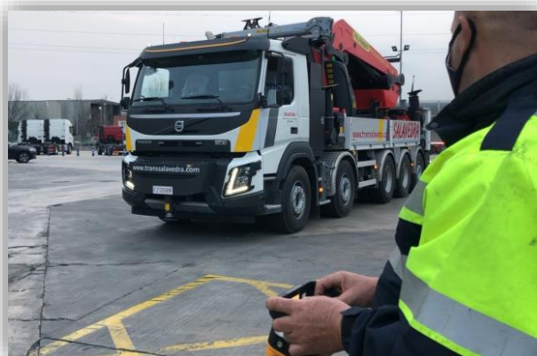
Camión teleoperado desarrollado por TELERADIO
